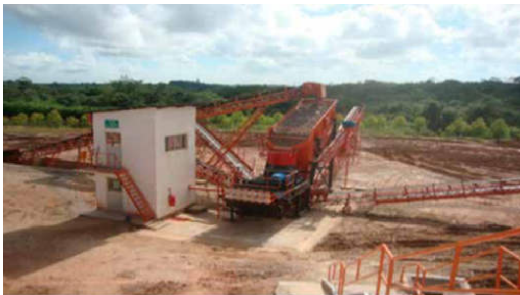
Figura 117: Complexo de britadores de mandíbula da Unidade de Reciclagem de Resíduos da Construção e Demolição – Nossa Senhora do Socorro. Crédito da foto: M&C Engenharia/2013.
