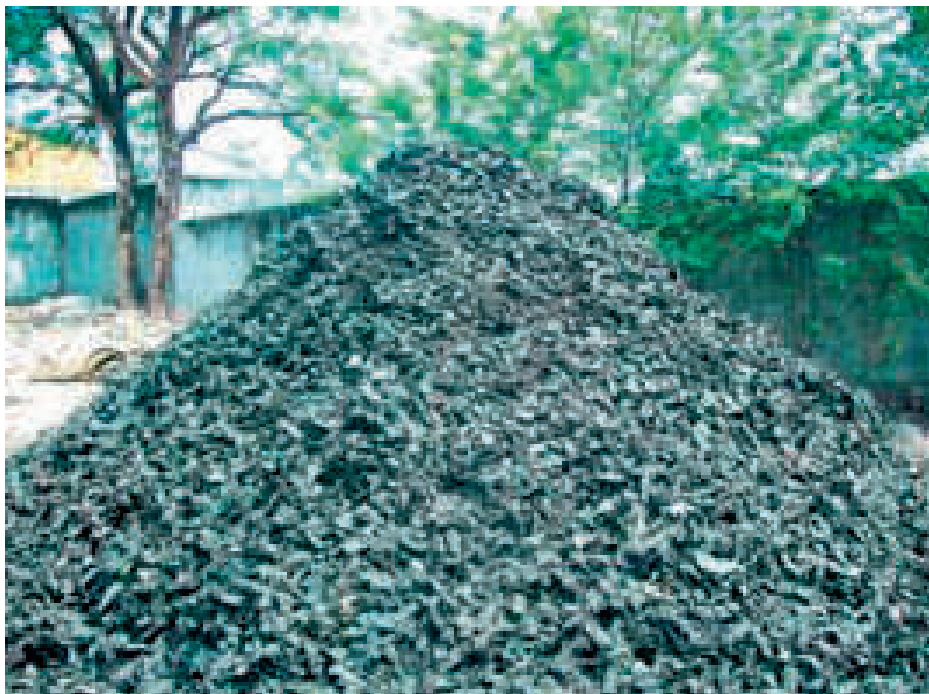
Figura 69: Pneus processados para utilização em forno de clínquer.
