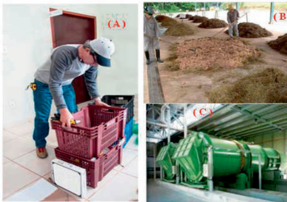
Figura 126: Fotografias de sistemas de transformação de resíduos orgânicos em composto (fertilizante orgânico); A: sistema familiar de compostagem, utilizando-se módulos de caixas plásticas vazadas; B: Pátio de compostagem, em Porto Trombetas-PA, 2013; C: sistema mecanizado de compostagem (em reatores rotativos, Maiorca-Espanha).
