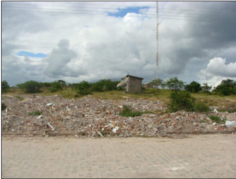
Figura 36: RCD: material inerte – Poço Redondo/SE.
