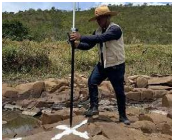
Levantamento batimétrico e implantação de pontos de controle para aerolevantamento por drone. (Fonte: SEMAC, 2025).
