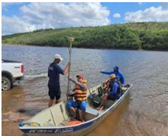
Levantamento batimétrico e implantação de pontos de controle para aerolevantamento por drone. (Fonte: SEMAC, 2025).
